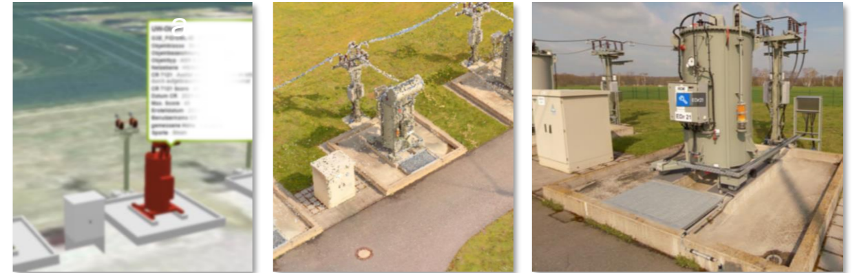
3D-Modelle (links), Punktwolken (Mitte) und 360° Foto (rechts) im Digitalen Zwilling der MITNETZ Strom
