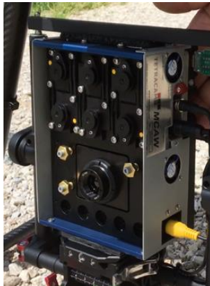
Tetracam (Multispektral) (aktuell im Einsatz 2x NIR, 2x Grün, 2x Rot, 1x Thermal)
